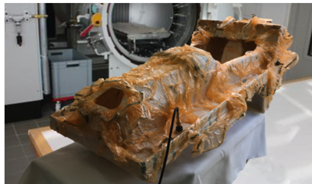
5 Worki próżniowe do cyklu utwardzania w autoklawie
